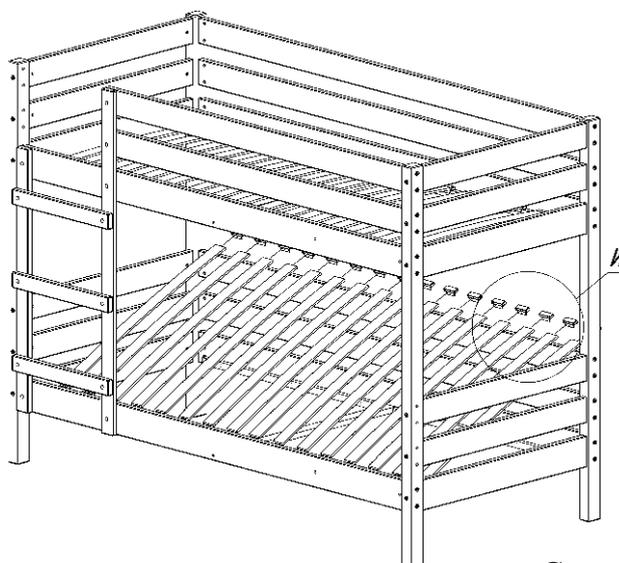
При помощи болта (поз. 11) и гайки ERICSONA (поз. 12) присоединить большую (поз. 8 и малую (поз. 9) стойки к царгам (поз. 2) и перилам малым (поз. 4). Установить ступеньки (поз. 10).
