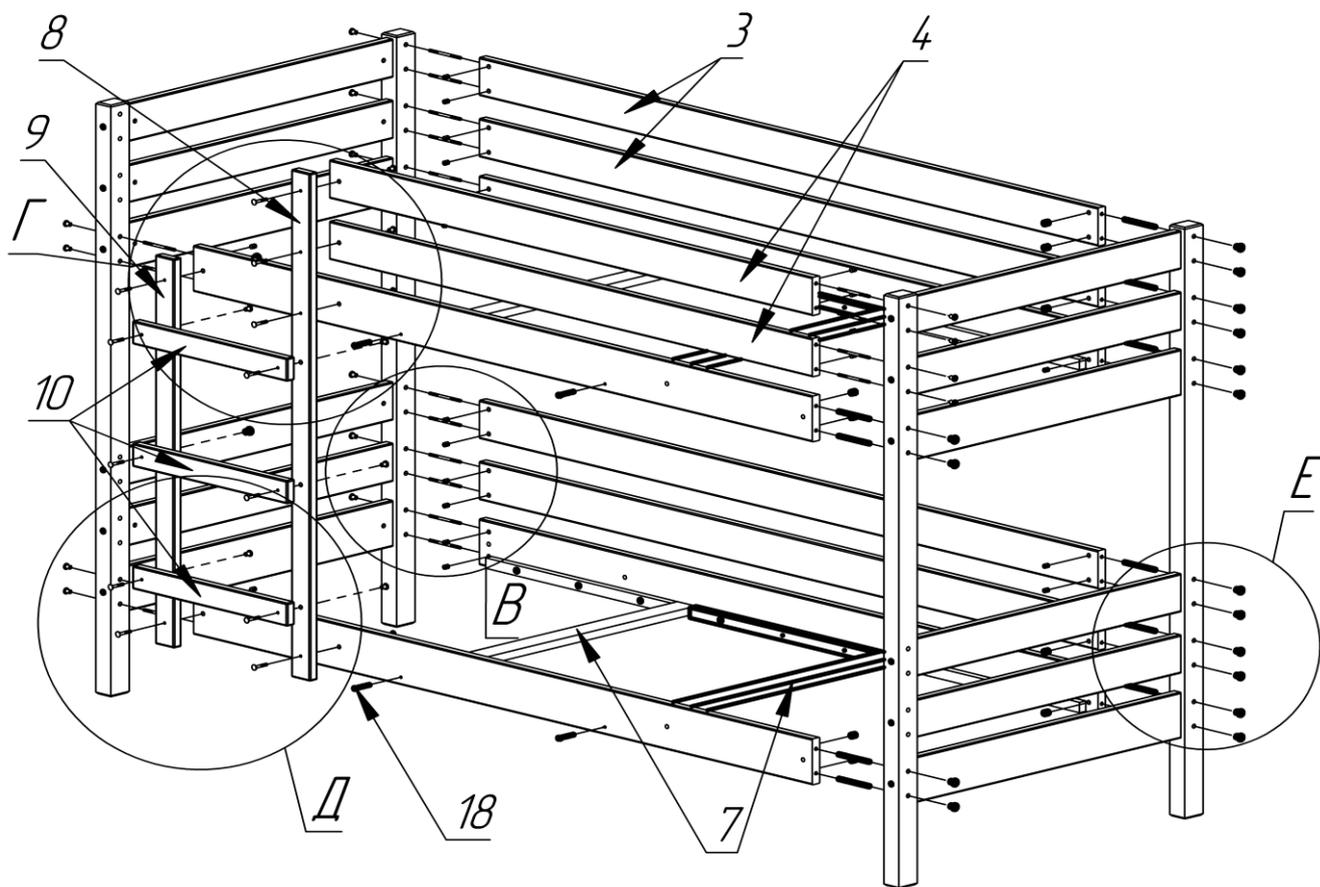
Присоединить царги к спинкам. Гайку ERICSONA (поз. 12) накрутить на шпильку (поз. 16) (Вид Е-стр. 3). Вставить муфты-бочонки (поз. 15) в отверстия, подставить царгу (поз. 2) к спинке, ориентируясь по присадочным отверстиям и при помощи ключа вкрутить шпильку с гайкой ERICSONA. Аналогично присоединить перила большие.
