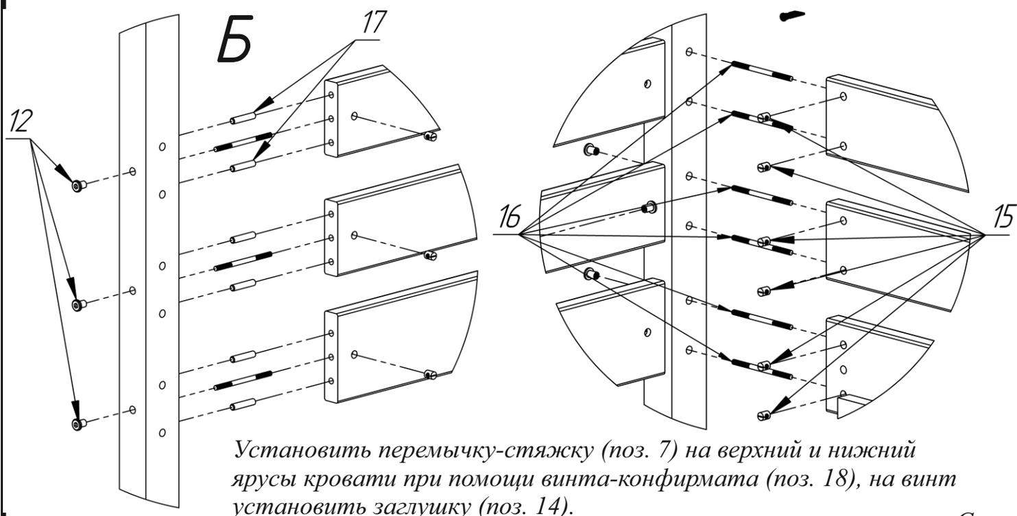
Установить перемычку-стяжку (поз. 7) на верхний и нижний ярусы кровати при помощи винта-конфирмата (поз. 18), на винт установить заглушку (поз. 14).
