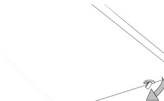
Повернуть фиксатор полкодержателя для предотвращения снятия полки.
