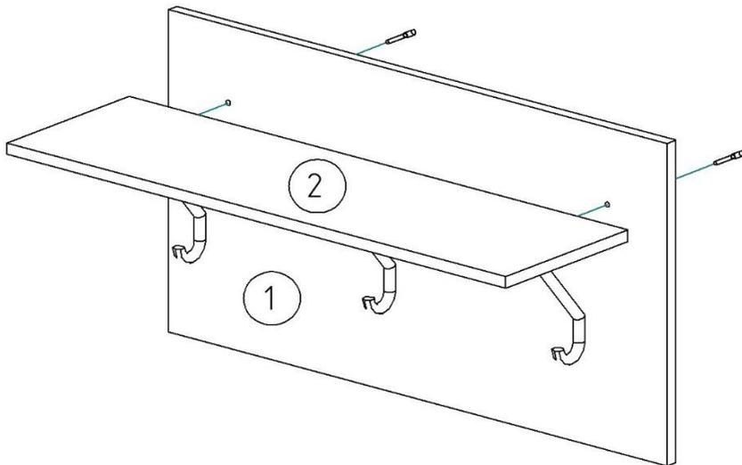
1. Соедините деталь 1 с деталью 2 с помощью винтов евро 7x50 мм.
