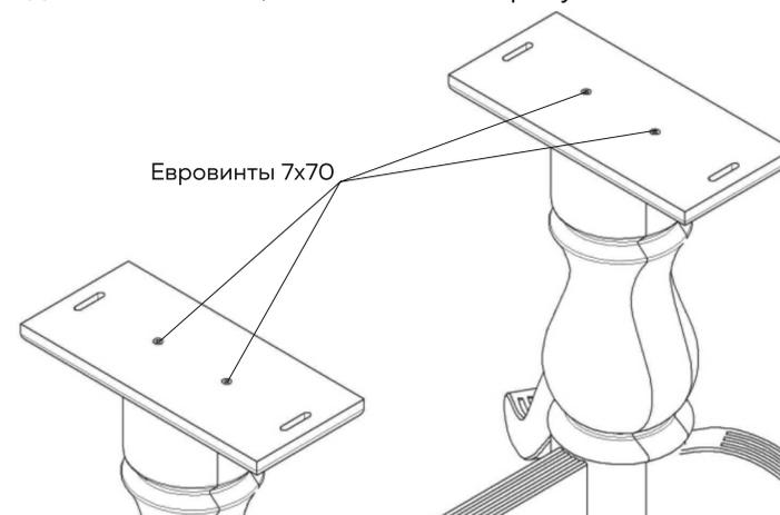
**5** Собранный стол присоединить к крышке с помощью ранее открученных винтов М6х30 и шайб, как показано на рисунке.
