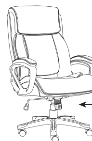
Регулировка жесткости качания / Тербелістің қаттылығын реттеу
