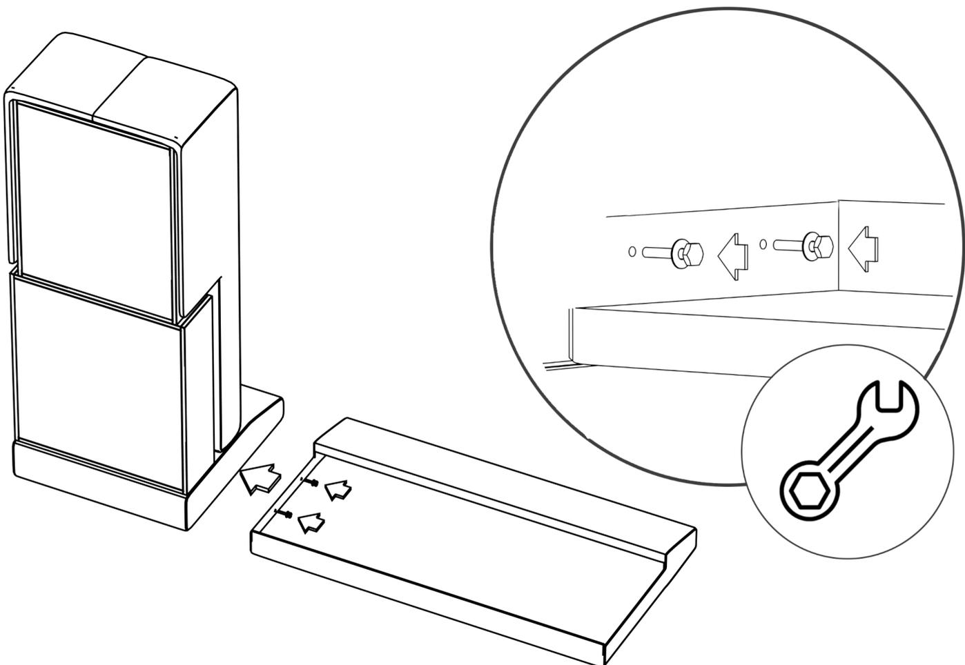
2. Справа от оттоманки, на полу, устанавливаем фальш спинку, крепим к оттоманке с помощью двух болтов М8 (ключ 13)
