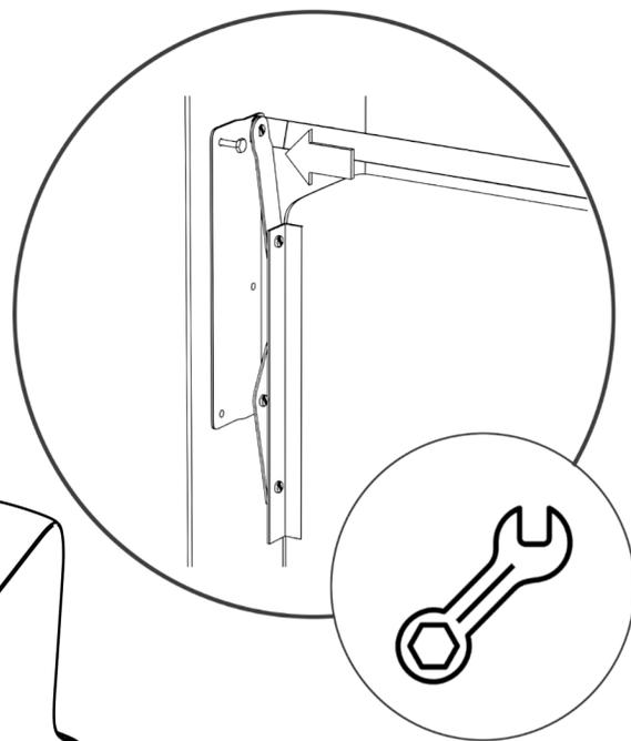
4. Установить посадочное место в положение, как на изображении. Приподнимая механизм посадочного места укрепить верхнюю часть с помощью болтов 6 шт. М8 (ключ 13) с обеих сторон. В целях удобства и безопасности рекомендуется производить данную процедуру вдвоем.
