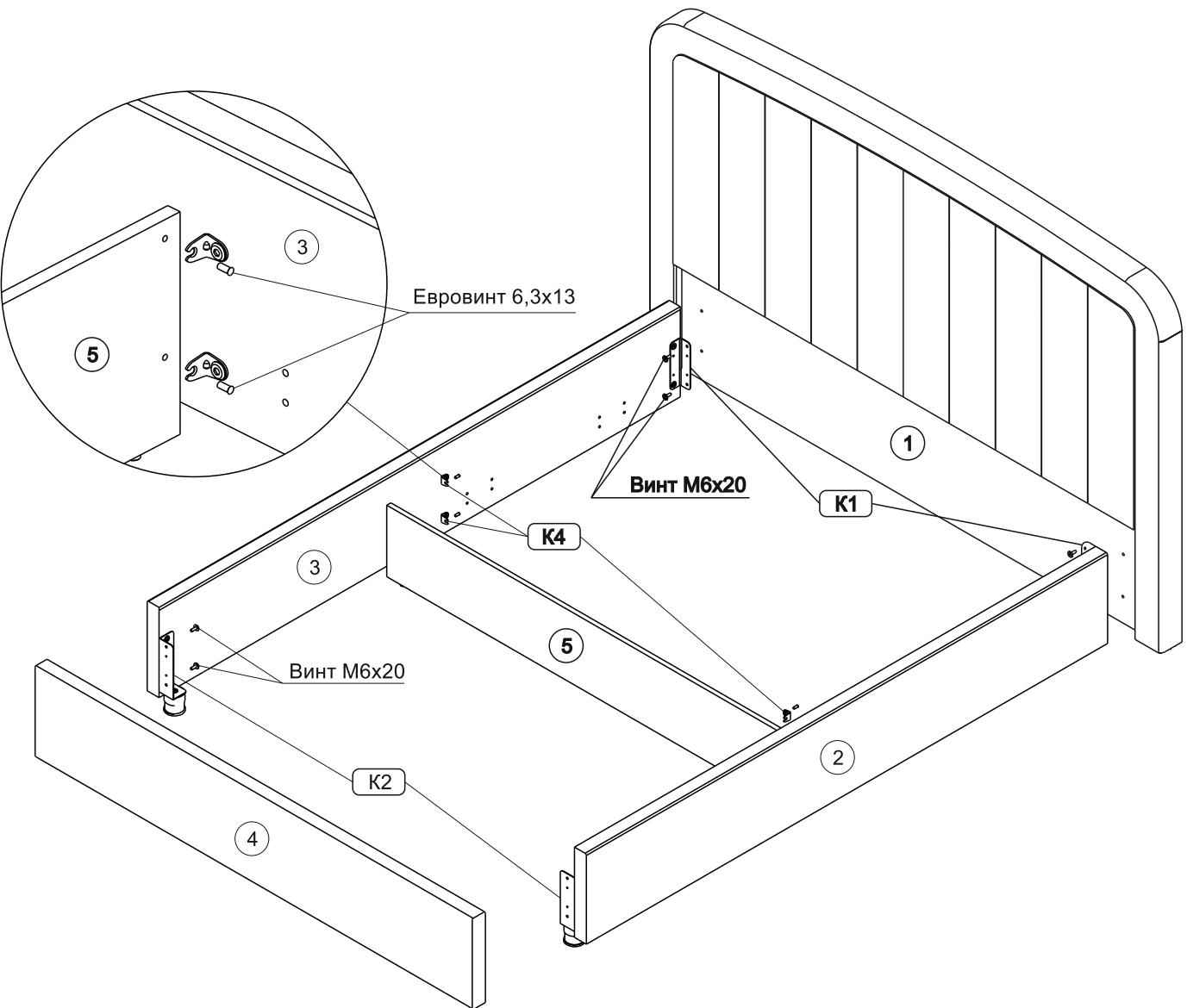
**Схема 3. Установка элементов подъемного основания ортопедического**
