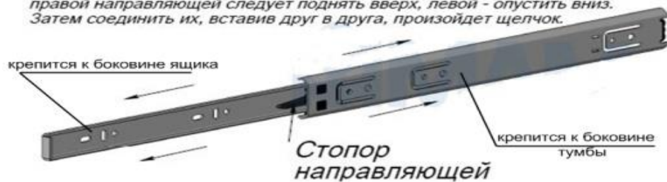
Рис.2 Схема установки шариковых направляющих
