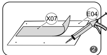
для более сильной фиксации рекомендуем использовать дополнительно клей-герметик типа жидкие гвозди. (Scotch-Seal 5300; Scotch-Wld 5300)
