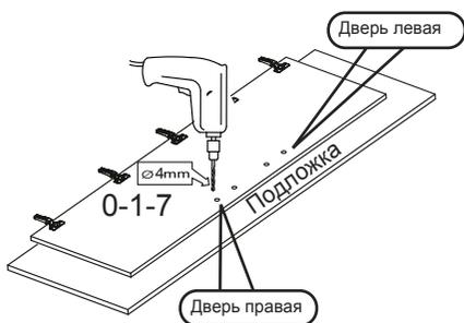
Сверлить необходимо на твердой поверхности, которую можно повредить, во избежание вырывания передней пласти детали.
