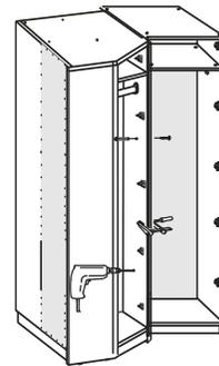
7. Крепление шкафа к стене, установка полкодержателей, полок.
