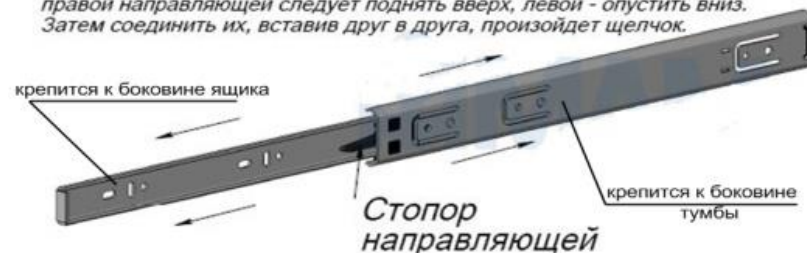
Рис.3 Схема установки шариковых направляющих
